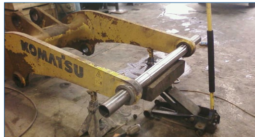
Arbre factice installé pour l'alignement
