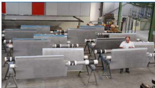
Directrices après sablage et application initiale
