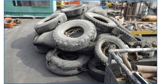
Inspection initiale d'une défense d'accostage dégonflée
