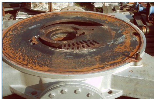
Plaque d'entrée avant l'application de Belzona 1111 (Super Metal)
