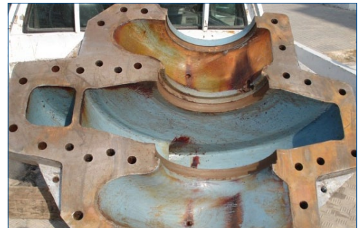
Revêtement en bon état après 3 ans et demi de service
