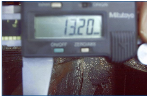
Mesure d'une palette de pompe intacte
