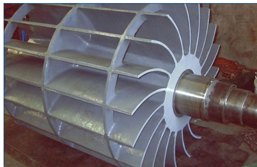
Après l'application du système Belzona 1311 (Ceramic R-Metal) et Belzona 1321 (Ceramic S-Metal)
