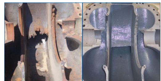
Les effets classiques de l'érosion/corrosion sur le bec à eau d'une pompe centrifuge Après la reconstruction et le revêtement avec Belzona
