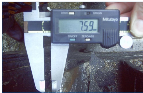
Mesure d'une palettes usée
