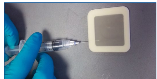
Une inspection approfondie de la contamination par le sel (chlorure y compris mesure de concentration) assure une préparation de surface optimale
