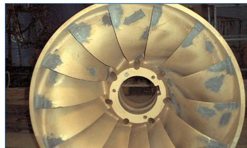
Application de Belzona 1341 (Supermetalgilde) en cours
