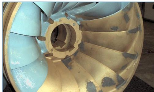
Turbine reconstruite en utilisant un matériau de grade pâteux afin de combler les zones souffrant de corrosion
