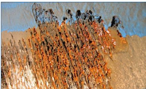
Fig 1: Dommages dus à la cavitation sur les pales
