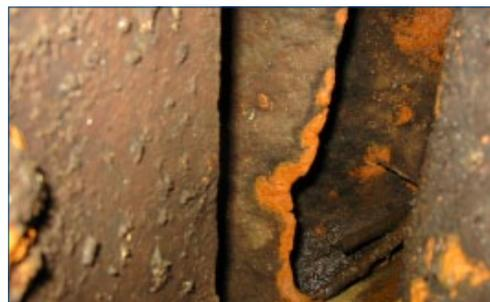
Fig 2 : Turbine détériorée
