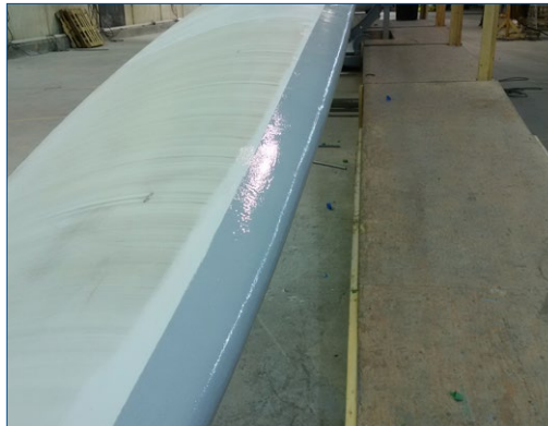
Détail de l'application de Belzona 1341
