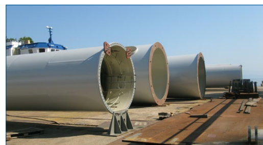
Réparation de tours avec Belzona 1211 Vol. XXXII, n° 33
