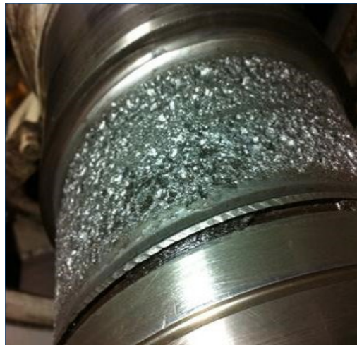
Arbre électrolysé avant réparation
