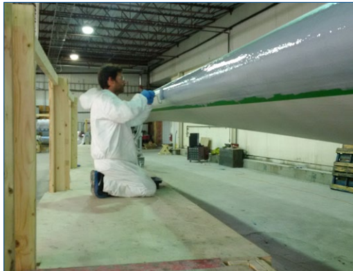
Belzona appliqué au rouleau sur le bord d'attaque
