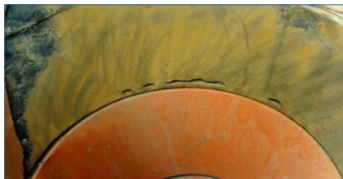
Échec du revêtement en caoutchouc
