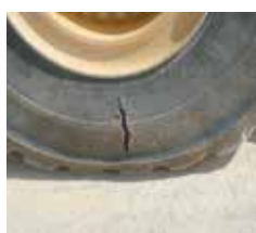
Fissure et déchirure réparées
