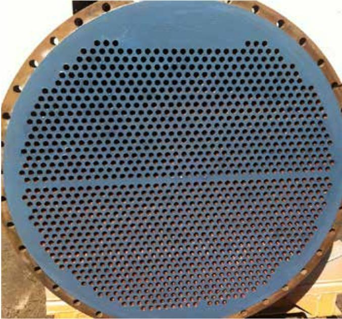
Belzona 1321 (Ceramic S-Metal) est un matériau bi-composants à haute résistance destiné à protéger l'équipement contre l'érosion et la corrosion.
