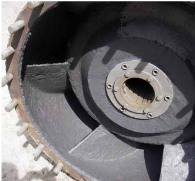
Belzona 1311 (Ceramic R-Metal) est un composite de réparation conçu pour reconstruire les métaux et les protéger contre les effets de l'érosion et de la corrosion.
