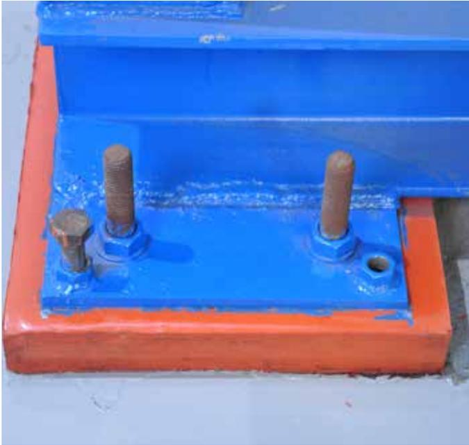
Belzona 7111 est un système versable de calage, de support et de mise à niveau qui a été développé pour résister aux efforts physiques et thermiques intenses exercés par les environnements marins et industriels.
