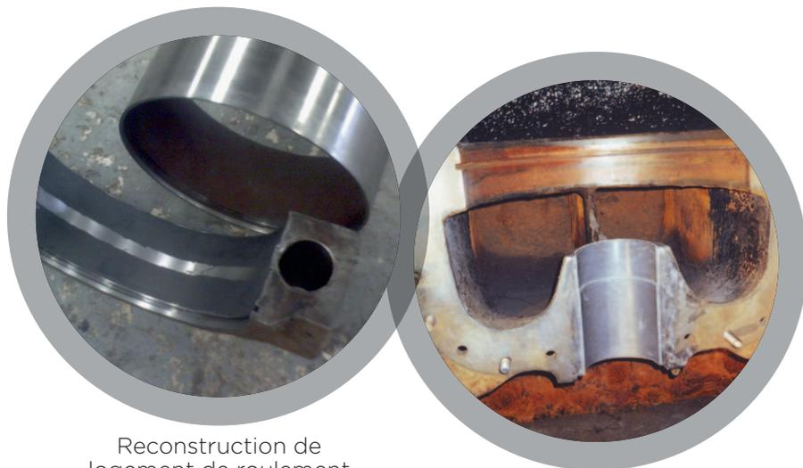
Reconstruction de logement de roulement
